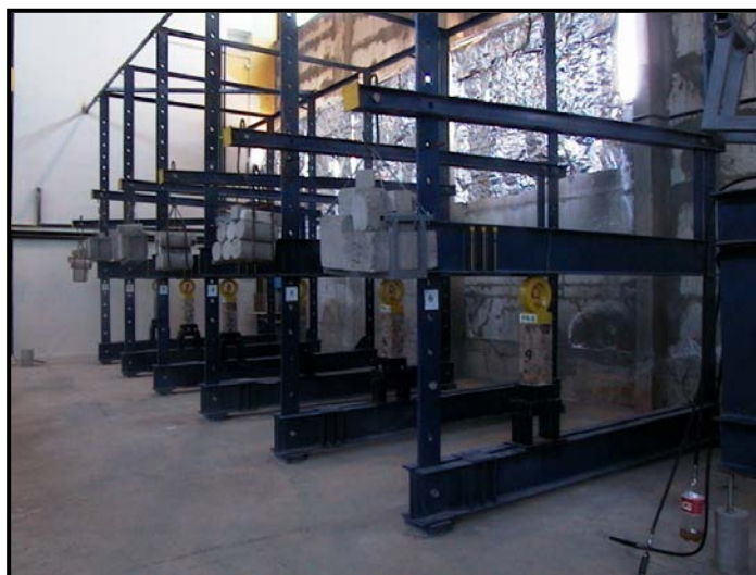
Slika 3. Uređaj za jednoosijalno opterećivanje pri testu puzanja Figure 3. Device for uniaxial loading during the creep test
