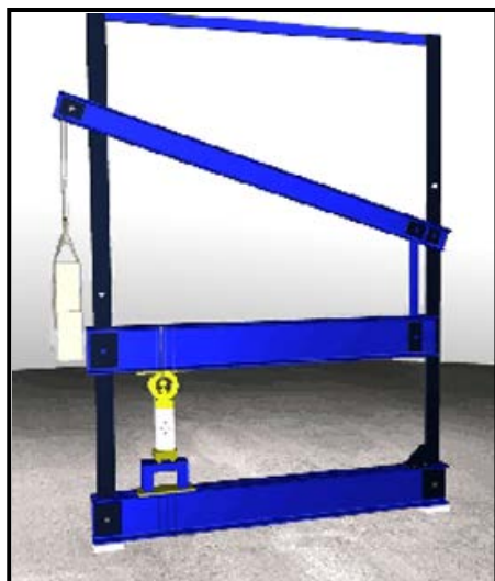
Slika 3. Uređaj za jednoosijalno opterećivanje pri testu puzanja Figure 3. Device for uniaxial loading during the creep test
