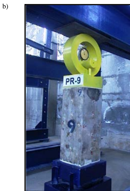
Slika 5. Prizmatični uzorak: a) šema mjernih mjesta; b) uzorak u toku testa puzanja (zaštićen parafinom) Figure 5. Prismatic sample: a) scheme of measurement points; b) samples during the creep test (coated by paraffin)
